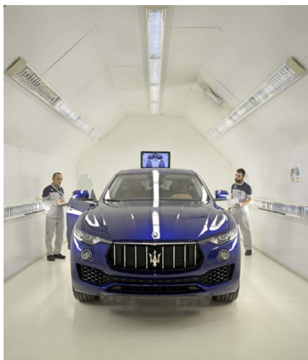
Grugliasco, Torino. FCA – Gruppo Fiat Chrysler Automobiles. Pergola per il controllo verniciature della linea Maserati (courtesy photo: Alessandro Lercara)
